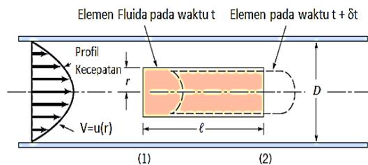
**Gambar 2.1. Pergerakan Elemen Fluida Silindris dalam Pipa**
