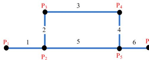
**Gambar 3.1. Model Fisik Pipa dengan Pembagian Elemen dan Nodal Tekanan**
