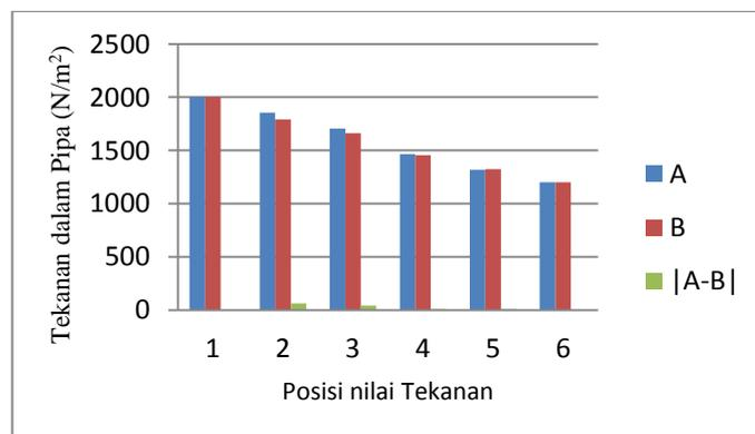
**Gambar 4.1. Nilai Tekanan dan Debit Aliran pada Tiap Elemen Pipa untuk Matrik Segitiga Atas (A) dan Bawah (B)**
